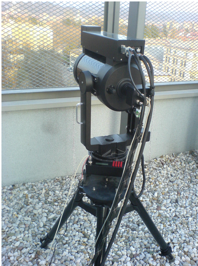
Slika 1.1: Fotografija merilnega dela našega lidarskega sistema z gibalnim modulom in stojalom.
